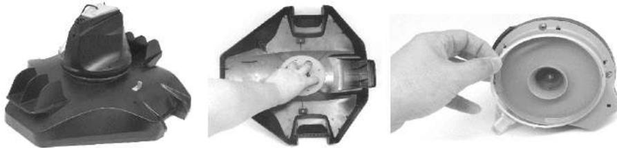
2. С помощью отвертки открутите 4 винта, расположенные на нижней части головки, чтобы сначала освободить нижнюю пластину. С помощью отвертки отвинтите все винты на основании, как показано на рисунке. Снимите крыльчатку, а затем поднимите основание и снимите его, чтобы открыть головку внутри.
